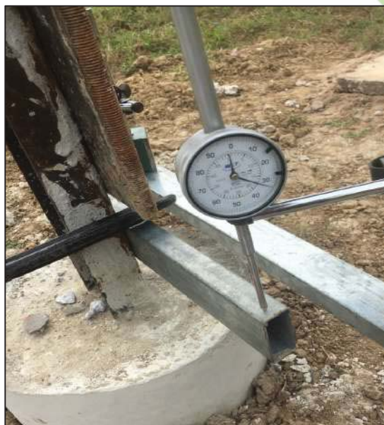
Thí nghiệm đẩy ngang cọc/ Lateral loading test
