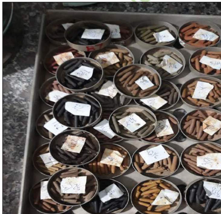
Thí nghiệm các chỉ tiêu đặc biệt của mẫu đất (Thí nghiệm nén cố kết C_v , thí nghiệm nén 3 trục sơ đồ CU, UU, CD, thí nghiệm mẫu nước/ Testing the special criteria of soil samples (Consolidation compression test C_v , 3-axis compression test CU, UU, CD diagram, water sample test...
