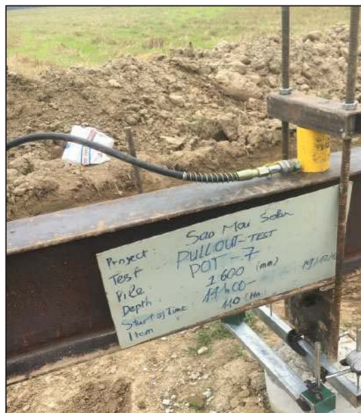
Thí nghiệm nhổ cọc/ Pull out loading test
