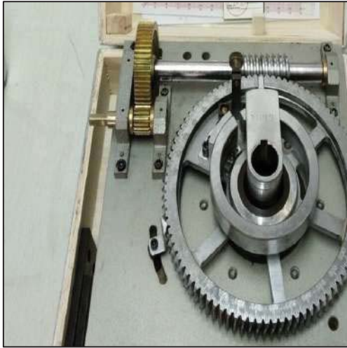
Bộ thí nghiệm cắt cánh hiện trường VST/ Field Vane Shear testing
